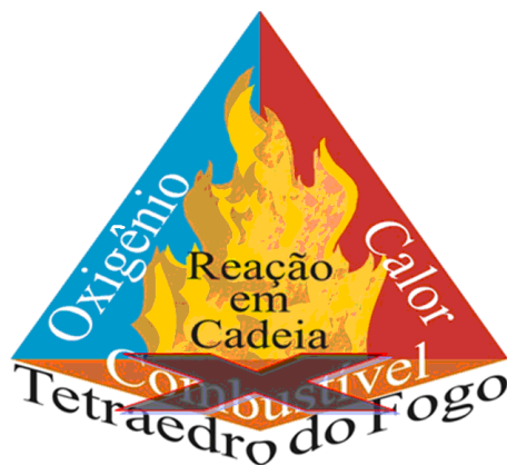
Figura 17 - Retirada do material combustível Fonte: 9ºGB - CBPMESP
